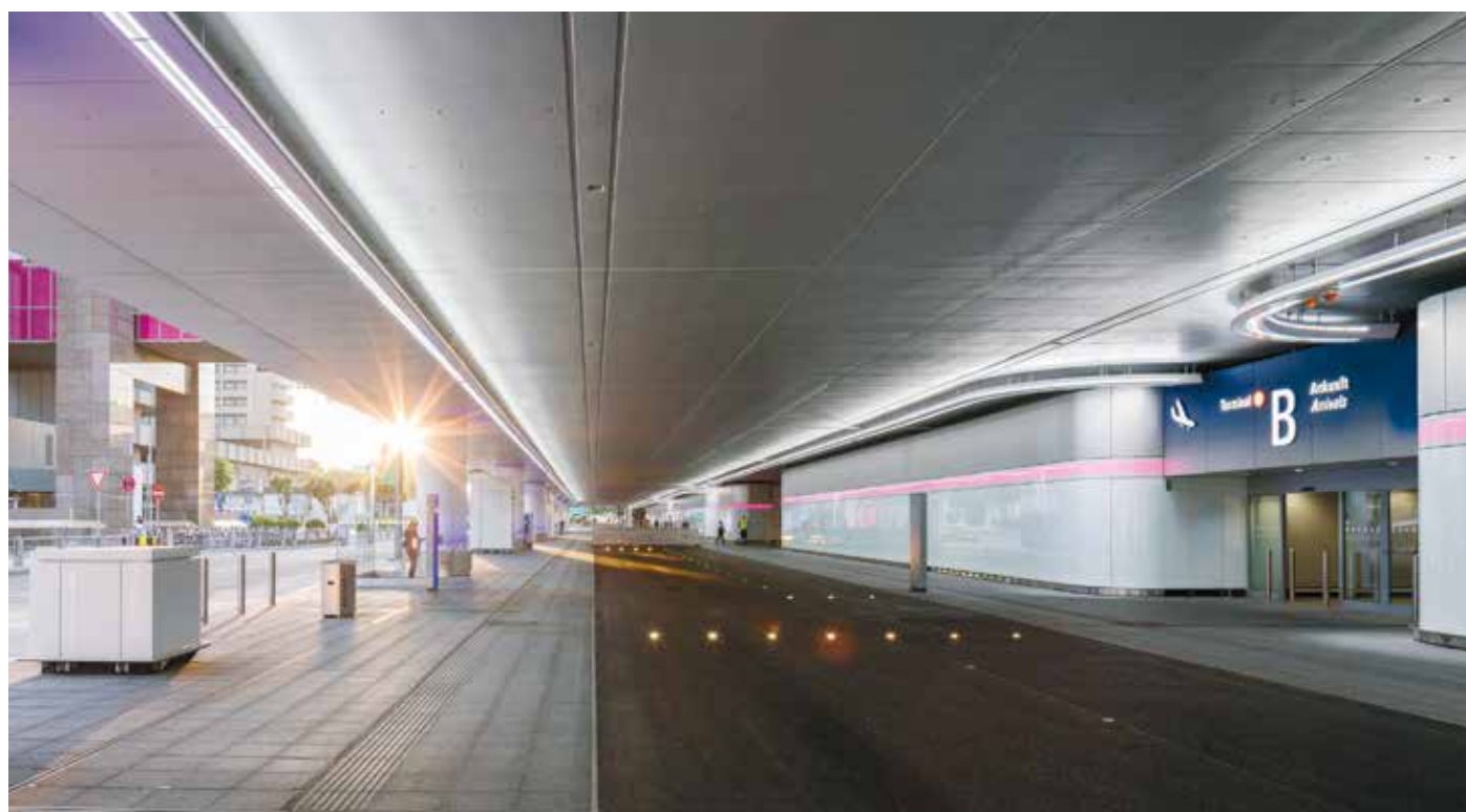
Abb.: Das Lichtprofil, das entlang der Fassade verläuft, öffnet sich in den neun Eingangsbereichen zum Terminal und schwingt bogenförmig auf die Türen zu. So zeichnet das Licht die Wegkonturen optisch nach und erleichtert Besuchern die Orientierung. (Foto: Jörg Hempel, Aachen)
